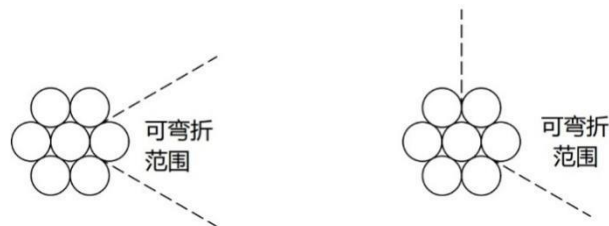
图 6 7 根钢管的几何限制（图片来源：作者自绘）
